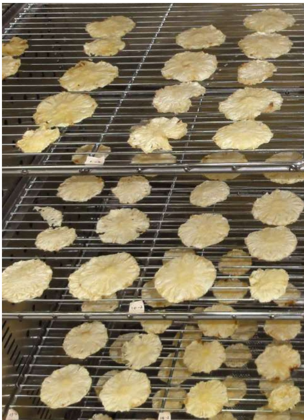
圖5 鳳梨進行冷風低溫乾燥
